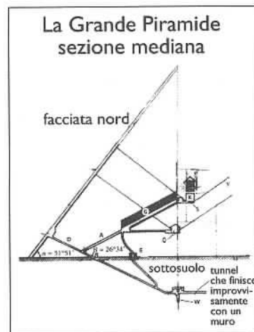
Fig. 9-41. Sezione trasversale della Grande Piramide.
