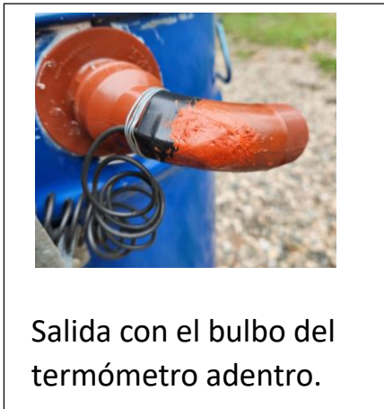
Vista de bulbo del termómetro dentro de la curva plástica.
