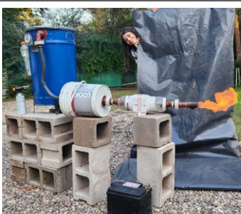
Purgado y venteo con el soplador
