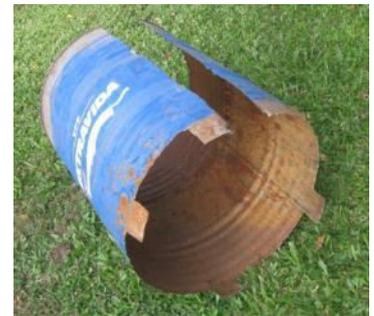
**Instalación de la aislación interior:** Se enrolla el tercer tabor dentro del tabor inferior, con las "patas" hacia abajo. Los agujeros del tabor inferior deben quedar libres entre las patas del tabor interior.
