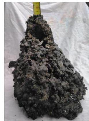
altura la base del fuego disminuyendo la autonomía del gasificador como se puede ver en la foto adjunta. El peso de esta escoria era de casi 1,2 kilogramos, por lo que luego de recorrer 100km a 80km/h se acumularían encima de la tobera casi 4 kilogramos de escoria.
