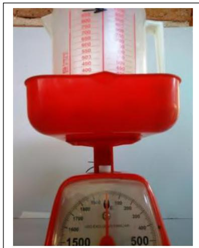
Ajustar la balanza a cero con la jarra vacía en la balanza.
