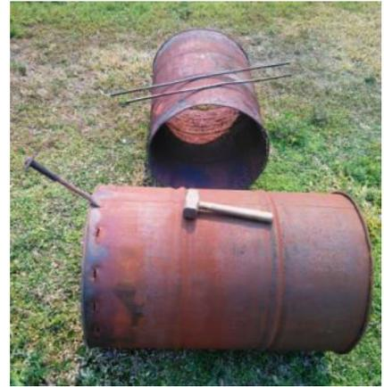
**Preparación de la aislación interior:** Este tercer tabor que ira dentro del tabor perforado, se le saca la tapa y la base, se corta a lo largo para poder enrollarlo dentro del tabor inferior y se le corta abajo como patas para que queden libres los agujeros del tabor exterior.
