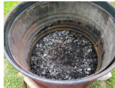
**Tal vez triturar y tamizar:** Finalmente, si la carga carbonizada tiene un tamaño entre los 3mm y los 20mm, ya está lista para gasificar en el gasificador. Por ejemplo las bellotas de roble o los carozos de aceituna. Pero si la carga es más grande de 20mm, se debe triturar arriba con una malla que tenga aberturas de 20mm y tamizar abajo con otra malla que tenga aberturas de 3mm. En el medio quedara la carga carbonizada con el tamaño adecuado para gasificar.
